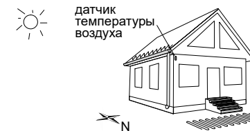
Рисунок 1. Монтаж датчика температуры воздуха
